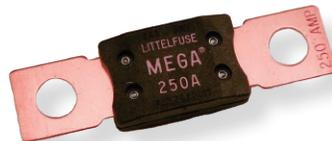
Los fusibles atornillables MEGA® varían de 40 A a 500 A y son ideales para proteger los cables eléctricos pesados que conectan la batería y el alternador. El fusible MEGA® está disponible en versiones de 32 V, 70 V y 120 V.
