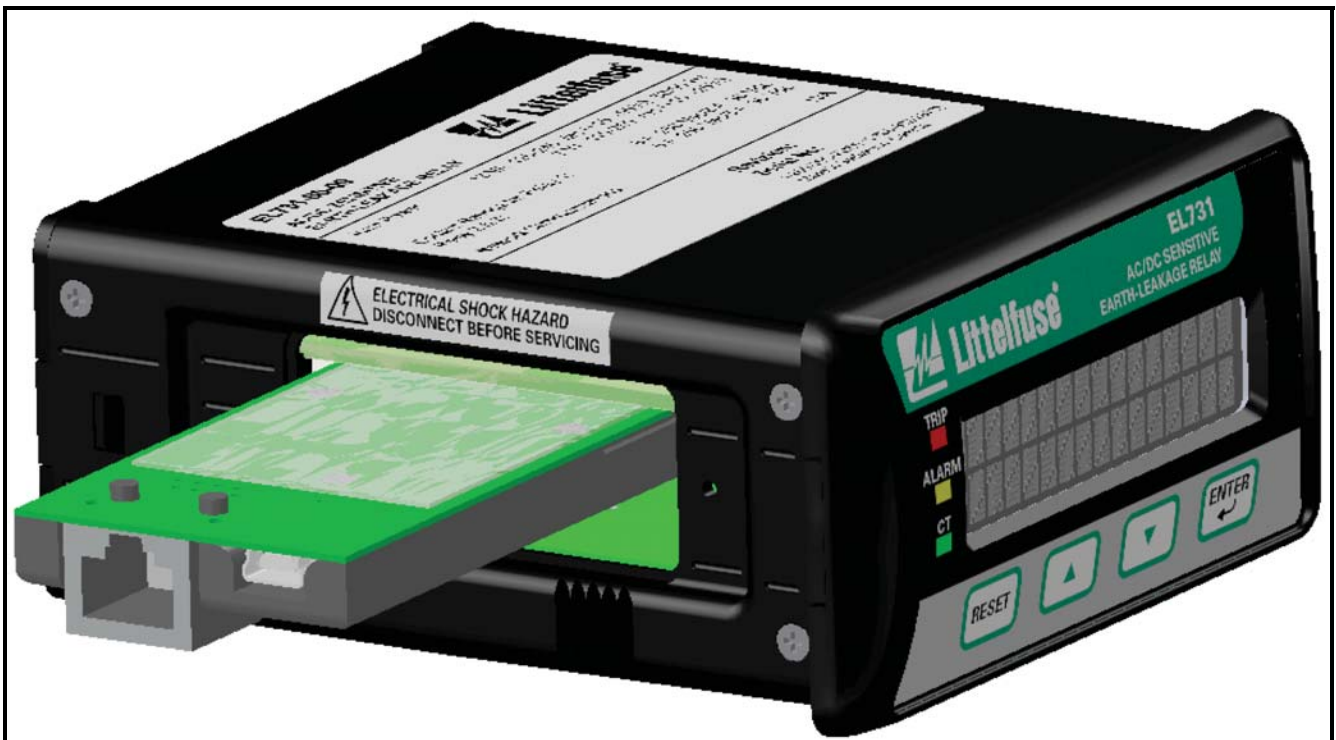
FIGURA 6. EL731 con adaptador de actualización de firmware (AC-700-CUA-00).
