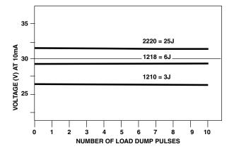
FIGURE 5. LOAD DUMP PULSING OVER A TEMPERATURE RANGE OF - 55°C TO 125°C
