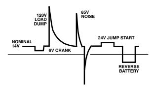
FIGURE 1. TYPICAL AUTOMOTIVE TRANSIENTS
