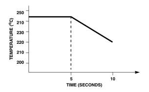
FIGURE 11. RECOMMENDED TIME AND SOLDER TEMPERATURE
