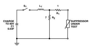
FIGURE 2B. LOAD DUMP SIMULATOR CIRCUIT
